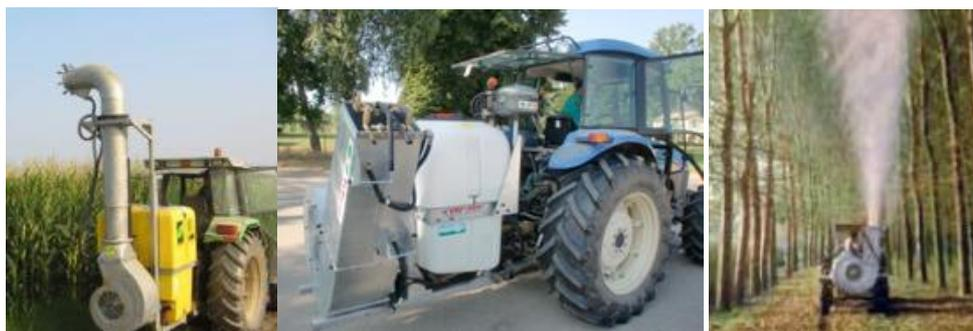
Fig. 181 - Esempi di irroratrici a cannone, molto sensibili alla deriva
