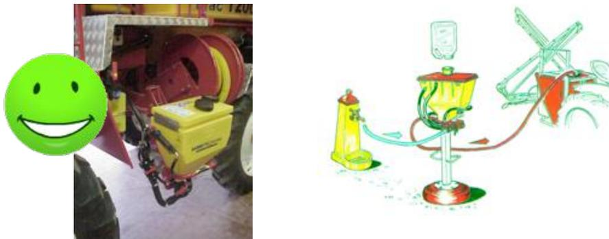
Fig. 63 – I premiscelatori possono essere montati direttamente sull'irroratrice (sinistra) oppure indipendenti (destra) ed alimentati direttamente dalla rete idrica dell'acquedotto.
