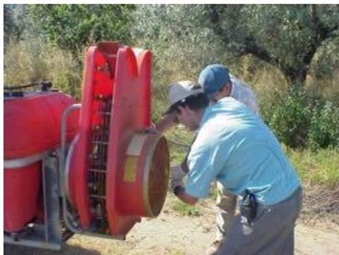
Fig. 148 – Regolazione dell'inclinazione delle pale.
