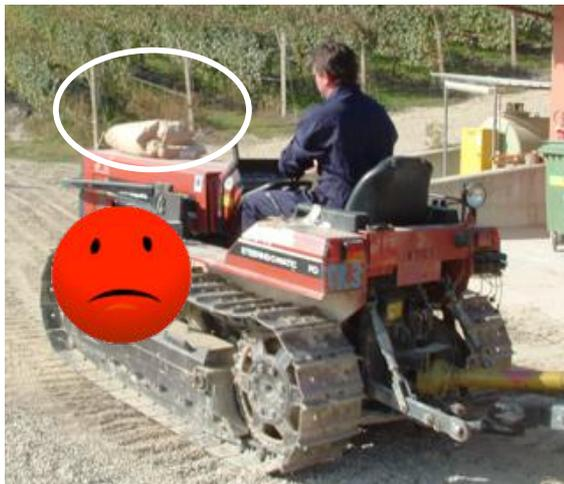
Fig. 6 – Trasporto di un sacco di prodotto in polvere in maniera NON sicura.
