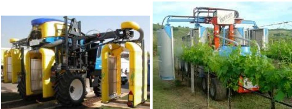
Fig. 163 - Esempi di irroratrici con sistema di recupero del liquido che oltrepassa il filare.
