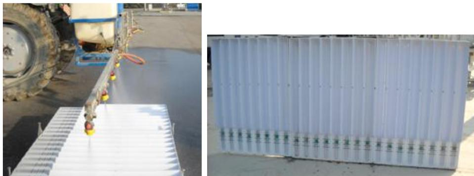
Fig. 180 - Attrezzatura utilizzata per misurare la qualità della distribuzione trasversale.
