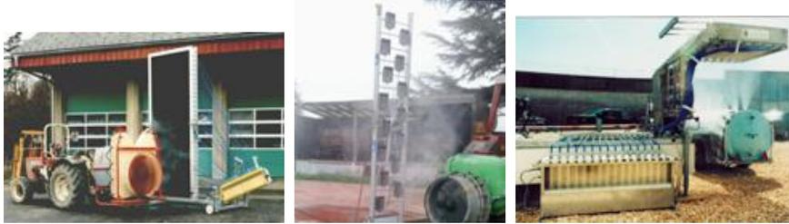
Fig. 176 – Esempi di banchi prova verticali.
