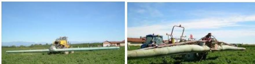
Fig. 177 - Barre irroratrici equipaggiate con manica d'aria
