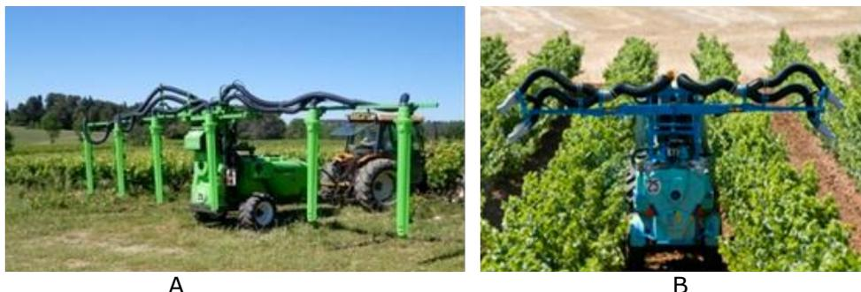
Fig. 183 - Irroratrice scavallante: A) con ugelli a polverizzazione idraulica; B) con diffusori pneumatici.
