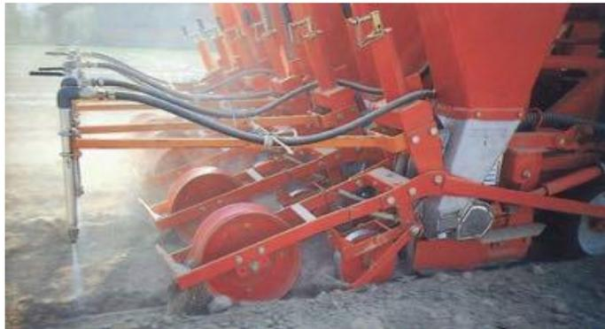
Fig. 158 – Irroratrice per diserbo localizzato abbinata a seminatrice.
