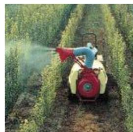
Fig. 140 – Irroratrice con cannone impiegata in vigneto.
