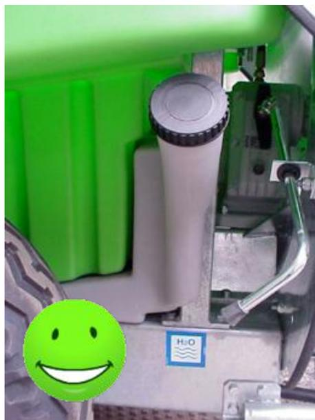
Fig. 39 – Il serbatoio lavaimpianto deve avere almeno il 10% della capacità nominale del serbatoio principale o almeno 10 volte il volume diluibile (EN ISO 16119). La sua presenza consente di effettuare in campo il lavaggio dell'irroratrice e lo smaltimento della miscela residua nel serbatoio principale. Deve essere progettato in modo da consentire il risciacquo delle tubazioni anche con il serbatoio principale pieno e la diluizione del residuo all'interno dello stesso.
