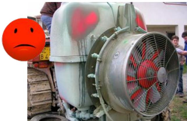
Fig. 35 - Esempio di macchina irroratrice in cui il getto erogato colpisce il serbatoio determinando il gocciolamento a terra della miscela fitoiatrice e causando, quindi, inquinamento puntiforme.
