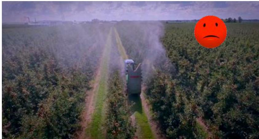
Fig. 72 – Distribuzione con evidente deriva al di sopra della vegetazione da trattare.
