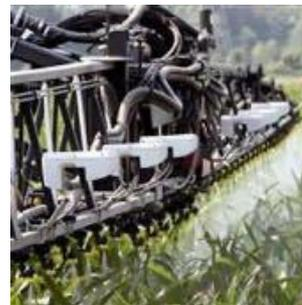
Fig. 160 - Irroratrice dotata di sensori per l'identificazione del bersaglio.
